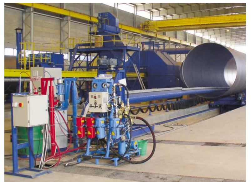
Automatische Rohrinnenbeschichtung von 18 m langen Trinkwasserrohren mit einem Ø von 3,10 m. Automated internal coating of potable water pipes with a Ø of 3.1m (10.2 ft.)
