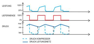
Geeignet für mittleren bis niedrigen Luftverbrauch mit langen Leerlaufperioden. Durch die Reduzierung der Leerlaufzeit wird Energie eingespart.
