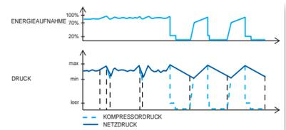
Geeignet für unterschiedliche Druckluftbedarfe. Die Steuerungseinheit MULTICONTROL passt sich automatisch an die Systeme F4 und/oder F5 an, je nach Art des Druckluftbedarfs.
