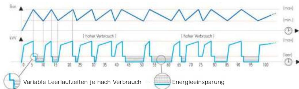
Wenn keine oder nur wenig Druckluft benötigt wird, läuft der Kompressor im Leerlauf, sobald der maximale Druckwert erreicht wird. Die Energieeinsparung wird durch Anhalten des Kompressors nach der kürzestmöglichen Leerlaufzeit erzielt, wodurch es möglich wird
