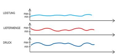
Geeignet für einen Druckluftbedarf, der in etwa dem Nenn-Volumenstrom des Kompressors entspricht und kurze Leerlaufzeiten aufweist. Es wird nur die Energie verbraucht, die zur Erzeugung der verwendeten Druckluft nötig ist.
