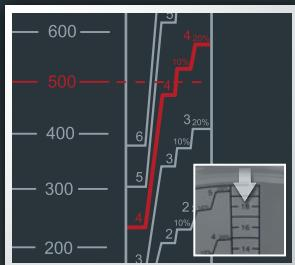
**DE** Jede Bechereinlage weist eine integrierte ml- bzw. oz-Skalierung auf. Fixieren Sie die benötigte Menge auf der ml- bzw. oz-Skalierung und ziehen Sie eine „gedachte Linie“ in die Spalte des benötigten Mischungsverhältnisses.
