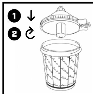
Vissez le couvercle avec le tamis inséré sur le gobelet.
