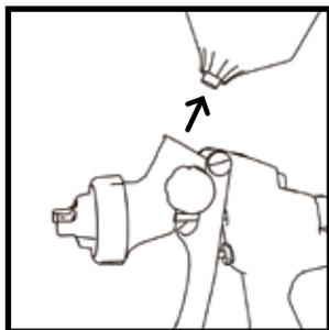
Retirez le gobelet d'écoulement existant du pistolet de pulvérisation.
