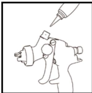
Abzugsbügel betätigen, gleichzeitig Reinigungsmittel zuführen. Fortfahren, bis die Reinigung vollständig abgeschlossen ist.
