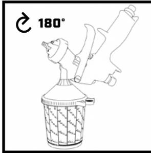
Gire la pistola de pulverización 180°. Presione brevemente la palanca del gatillo de la pistola para drenar la pintura del canal de color de la pistola.
