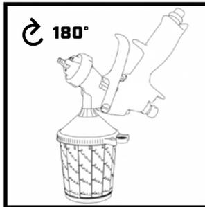
Drehen Sie die Spritzpistole um 180°. Betätigen Sie kurz den Abzugsbügel der Pistole, um die Farbe aus dem Farbkanal der Pistole abzuleiten.
