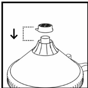
Entfernen Sie die Verschlusskappe vom Deckel und verschließen Sie den Becher.
