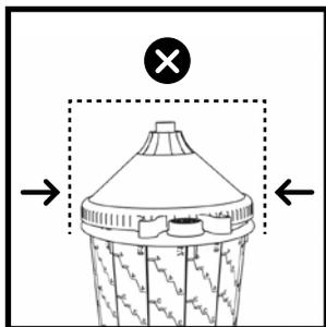
Wird der Becher gequetscht, erschwert dies das Auf- und Zuschrauben des Deckels.
