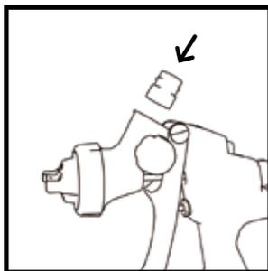
Fixez l'adaptateur à vis approprié sur le pistolet de pulvérisation (voir liste des adaptateurs).
