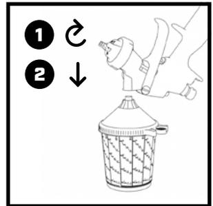
Entfernen Sie den Becher durch leichtes Drehen und Ziehen von dem Adapter.
