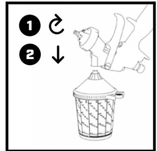
Retirez le gobelet en le tournant légèrement et en le tirant de l'adaptateur.
