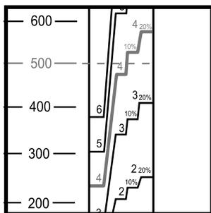
Cada vaso tiene una escala de ml u oz. Fije la cantidad requerida en la escala de ml u oz y trace una "línea imaginaria" en la columna de la proporción de mezcla requerida.
