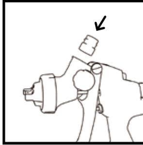
Fije el adaptador de tornillo adecuado a la pistola de pulverización (consulte la lista de adaptadores).
