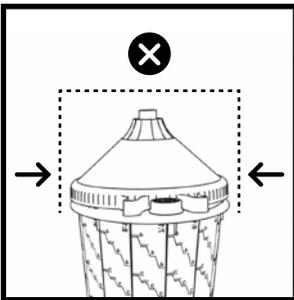
Si se aprieta el vaso, esto dificulta el atornillado y desatornillado de la tapa.
