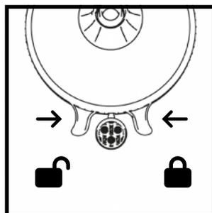
Les broches DrehFix robustes et ergonomiquement conçues garantissent un vissage et un dévissage faciles et sécurisés du couvercle, sans écraser le gobelet.
