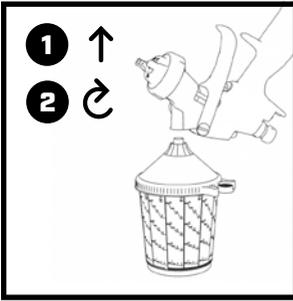
Fixez le gobelet en appuyant légèrement et en le tournant sur l'adaptateur.
