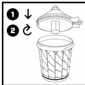
Schrauben Sie den Deckel mit dem eingesetzten Sieb auf den Becher.
